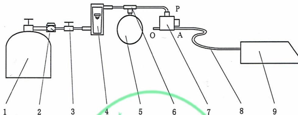
1—标准气体钢瓶；2—减压阀；3—节流阀；4—浮子流量计；5—气囊；6—三通接头；
